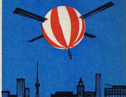
Model amerykańskiego sterowca wirującego „Aerocrane”, wyposażonego w wirnik z czterema łopatkami o regulowanym kącie natarcia
